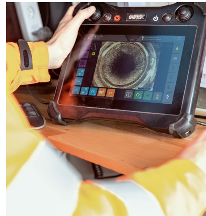
Monitor zur Überwachung von Kanal-TV-Aufnahmen
