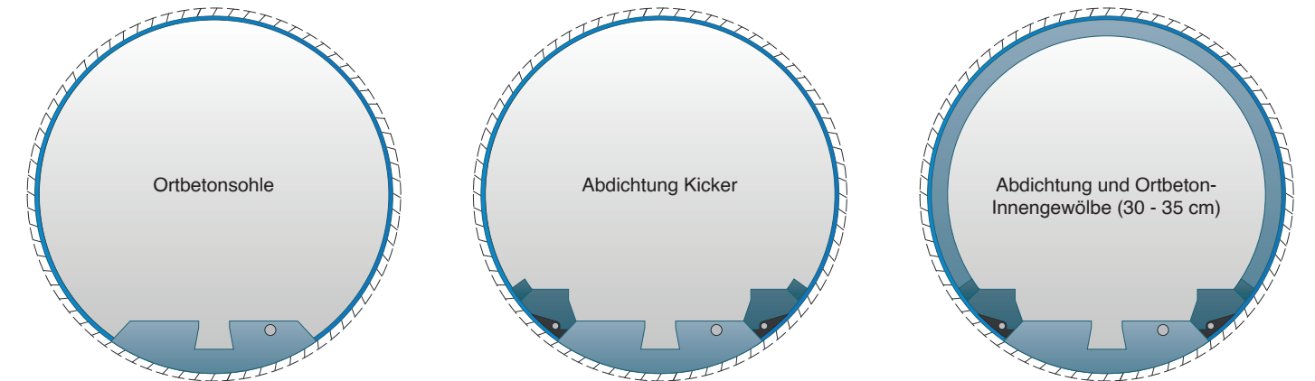
Schrittweiser Aufbau des Innengewölbes in drei Etappen, Beispiel Gotthard-Basistunnel (Quelle: ATG)
