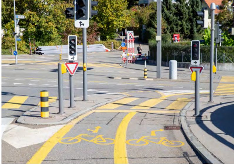
Markierungen der Velospur vor Lichtsignalanlage
